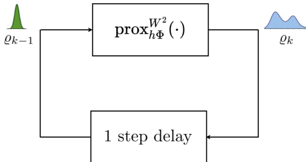
Proximal operator:  $\varrho_k = \text{prox}_{h\Phi}^{W^2}(\varrho_{k-1}) := \arg \inf_{\varrho \in \mathcal{P}_2(\mathcal{X})} \left\{ \frac{1}{2} W^2(\varrho, \varrho_{k-1}) + h\Phi(\varrho) \right\}$
